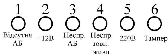
Рисунок 5.4 – Розширена індикація несправностей живлення для 8П.1
