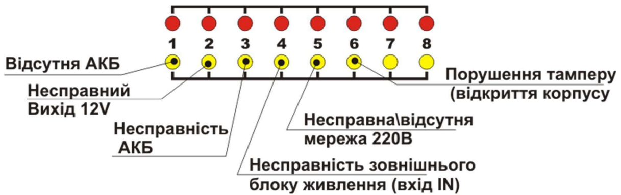
Рисунок 5.2 - Розширена індикація несправностей живлення для Тірас-8П.1
