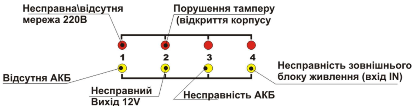
Рисунок 5.1 - Розширена індикація несправностей живлення для Тірас-4П.1
