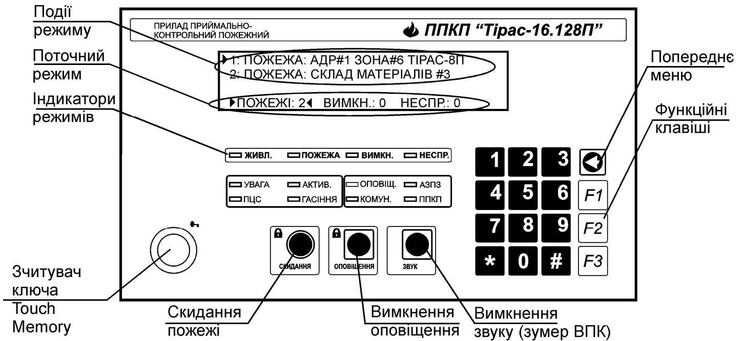
Рис. 1 – зовнішній вигляд виносної панелі керування (ВПК).
