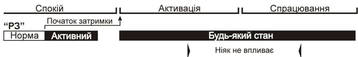
Рисунок 4.5 - Алгоритм роботи входу «P3»
