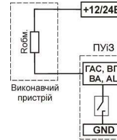
Рисунок А.6 - Загальна схема підключення виходів типу «відкритий колектор»
