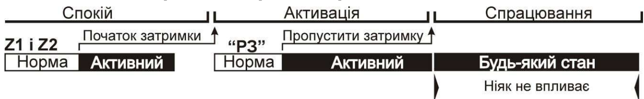
Рисунок 4.4 - Алгоритм роботи при активації входів «Z1» і «Z2»
