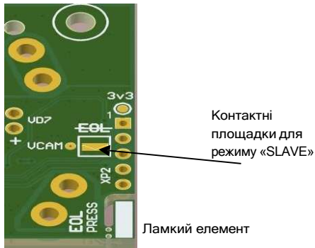
Рисунок 4.4 - Розміщення лампкого елемента та контактних площадок для режиму «SLAVE» на платі
