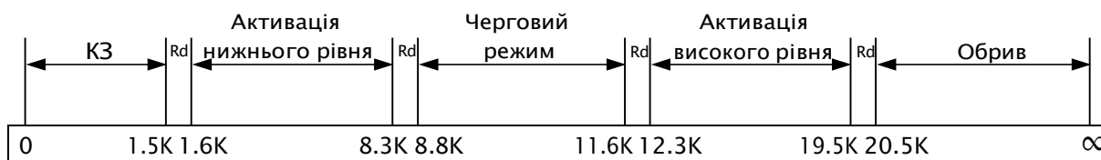
Рисунок 6 – Графік значення опору лінії відповідно до стану пристрою
