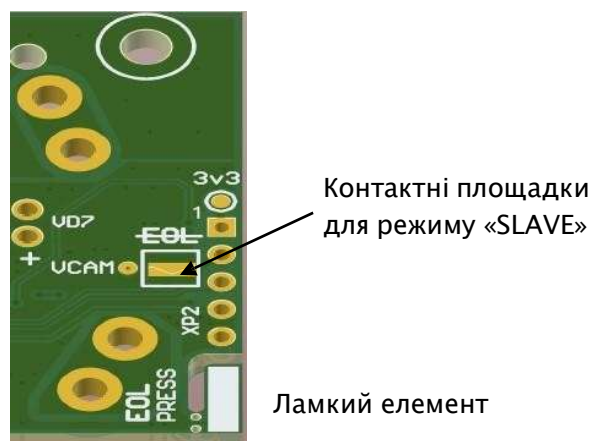
Рисунок 6.1 – Розміщення ламкого елемента та контактних площадок EOL на платі сповіщувача
