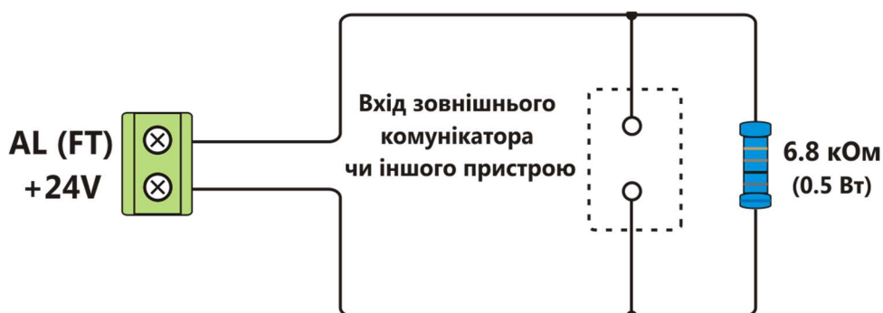
Рисунок 9 - Підключення виходів AL та FT
