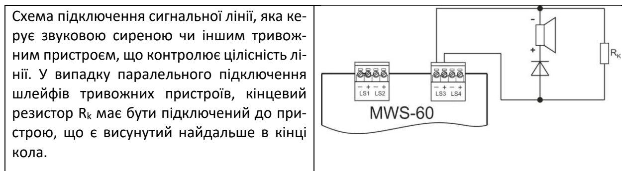
Мал. 7.5/2 Модуль MWS-60 – підключення
