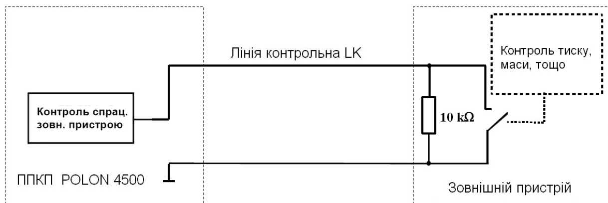
Мал. 5.7 Приклад використання контрольної лінії, для контролю справності зовнішніх пристроїв
