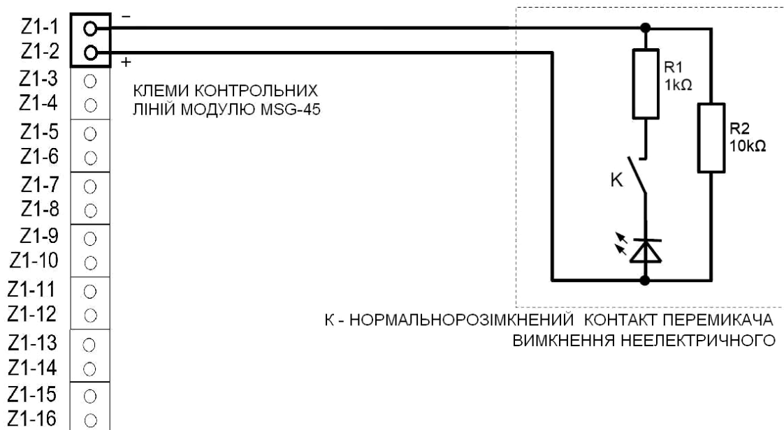
Мал. 9.10 Схема контрольної лінії для реалізації функції НЕЕЛЕКТРИЧНОГО ВИМКНЕННЯ
