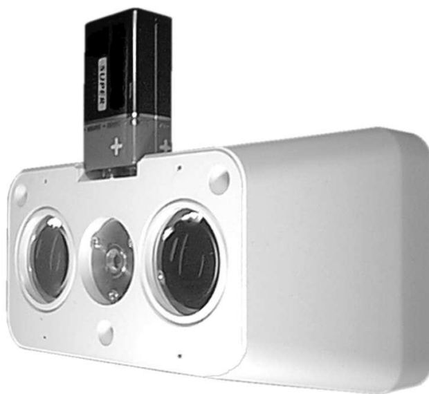
Рис. 2 Извещатель DOP-6001 во время настройки оптической траектории
