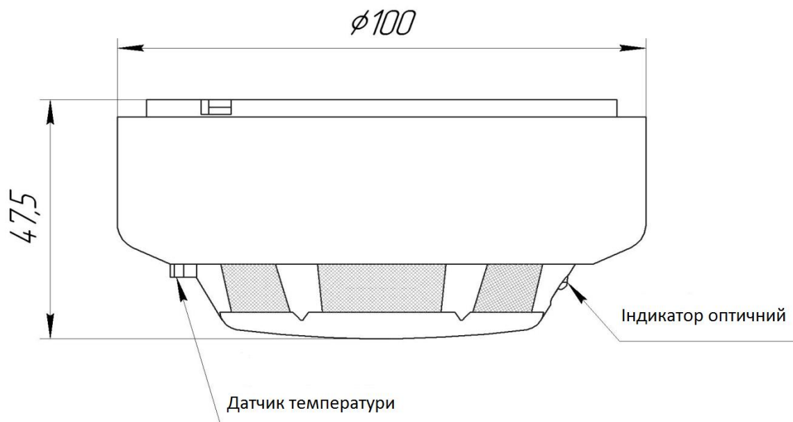
Малюнок 1а – Зовнішній вигляд димових і комбінованих сповіщувачів ИПК-1...ИПК-6.
