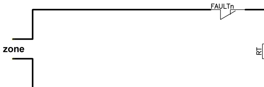
Малюнок 4 – Підключення поодиноких контактів «FAULT» до шлейфу сигналізації
