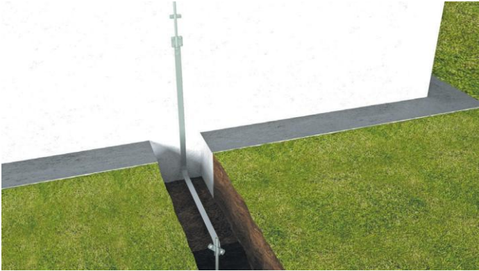
Заземлення струмоспуску Conductor grounding
