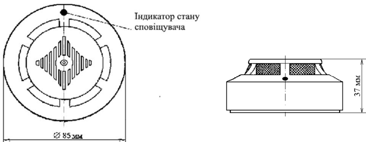
Мал. 1 Загальний вигляд та габаритні розміри сповіщувача
